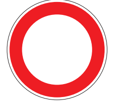
Prohibición de circulación de toda clase de vehículos
